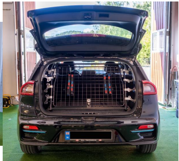
1/9-2022 Kia E-Niro - bilen på bilden hade ett golv i låg nivå så bilägaren har "byggt" upp golvet så att golvet bli mer i nivå med tröskeln för annars hade grindens dörr aldrig kunna öppnats Artfex Grind Modell 1 Enkeldörr art nr 10008
